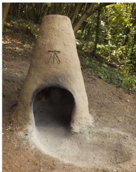
3. Ábra: a) A kohó vázlatos rajza a főbb részekkel és méretekkel. b) A kitisztított kohó, előtte salakgödörrel. c) A kohó üzem közben centrifugál ventilátorral fújtatva és hőszigetelő porral körbevéve.
