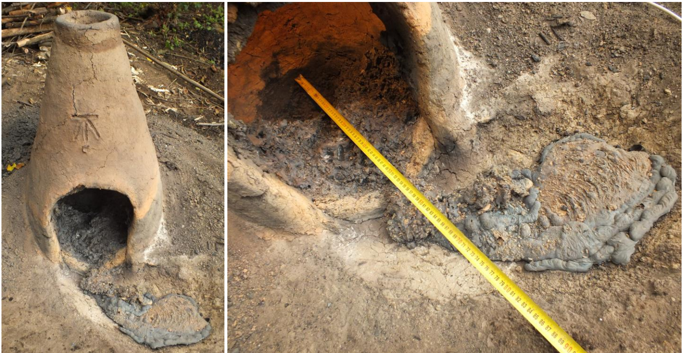
9. ábra: A IV. kohósítás után a kohóban maradt salakmedve és a kohó elé kifolyt folyósalak.
