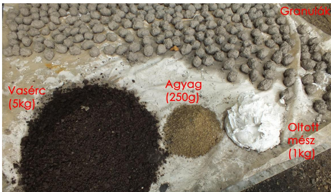
7. ábra: Granulák 1 : 0,2 : 0,05 = érc : oltott més : agyag arányok mellett
