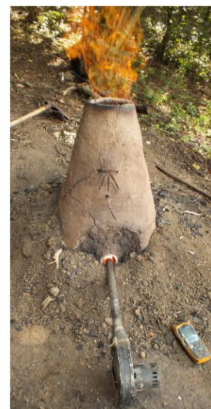
3. Ábra: a) A kohó vázlatos rajza a főbb részekkel és méretekkel. b) A kitisztított kohó, előtte salakgödörrel. c) A kohó üzem közben centrifugál ventilátorral fújtatva és hőszigetelő porral körbevéve.
