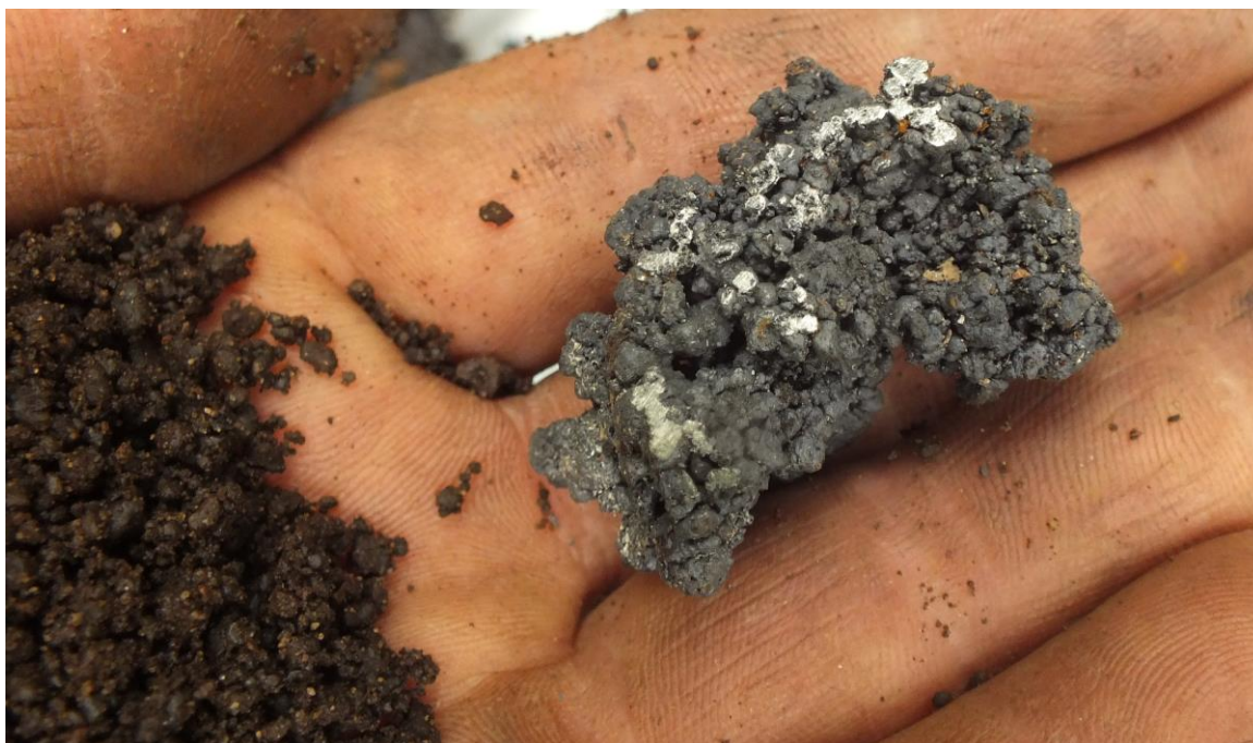
6. ábra: Fémtisztára csiszolt vasszivacs darabka és az apró szemű petesmalmi gyevasérc.
